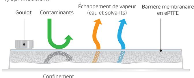
La surface du plateau en ePTFE est chimiquement inerte, biocompatible et équipée d'un bouchon pratique pour le remplissage. Le fond du plateau, constitué d'un film de souple, s'adapte parfaitement aux étagères des lyophilisateurs pour permettre un transfert de chaleur uniforme et efficace.
